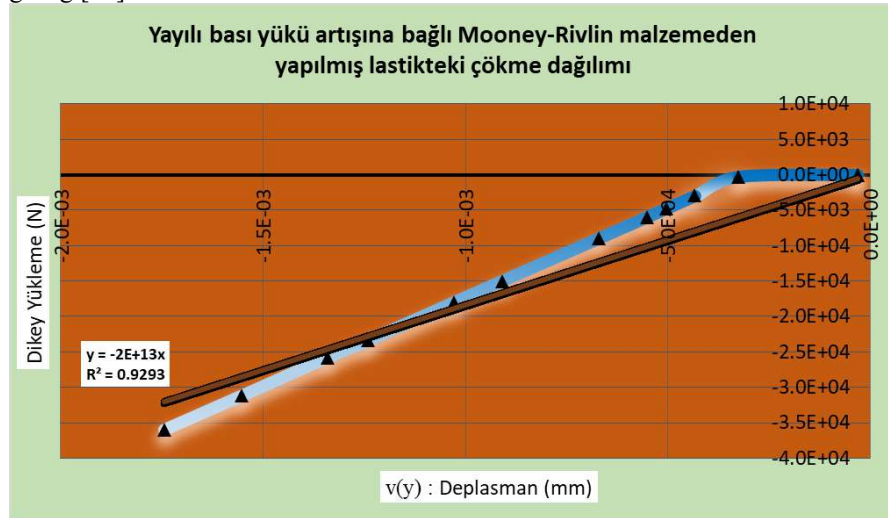
Şekil 3b. Modele uygulanan dikey yayılı yükün, y ekseninde boyunda plastik tekerlekte oluşturduğu v(y) dikey çökme dağılımı (FEA_M6)
