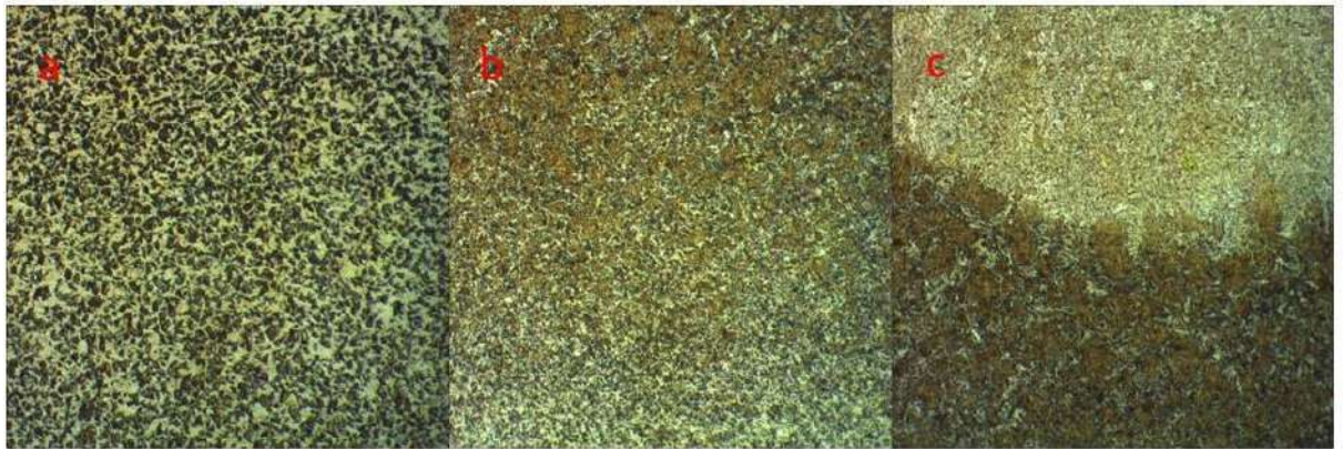
Şekil 4. Numune 1 a) Ana malzeme b) ITAB-Ana malzeme geçiş bölgesi c) ITAB- kaynak dikiş bölgesi
