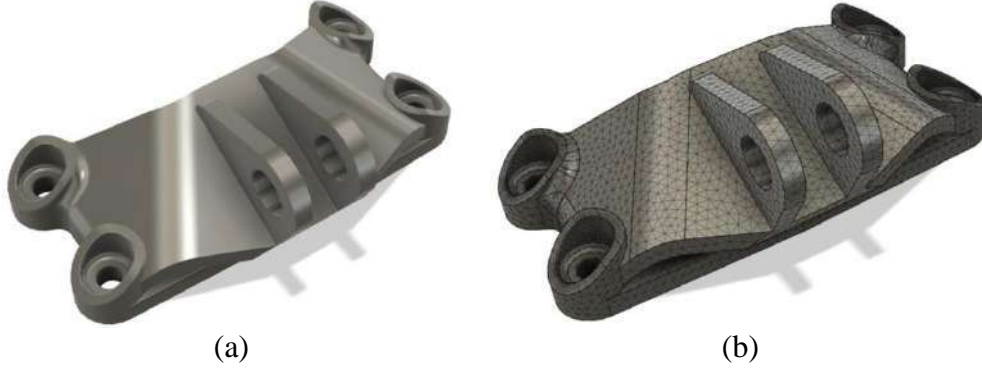
Şekil 6. Optimizasyon için sınır koşulları belirlenmiş braket tasarımı ve çözüm ağı
