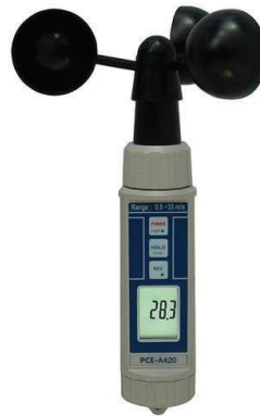
Şekil 3. Ölçümlerde kullanılan kaşık tipi anemometrenin görseli.
