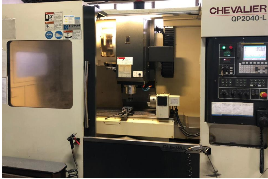
Şekil 1. Deneyin gerçekleştirildiği Chevalier QP2040-L tipi CNC Freze tezgahı
