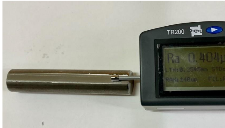
Şekil 6. Deney numunesinden pürüzlülük ölçümü
